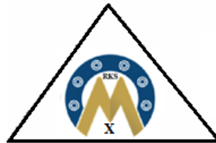
b. Verifikacioni pečat za merne instrumente koji podležu samo početnoj verifikaciji
